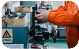
钢丝弯曲试验
