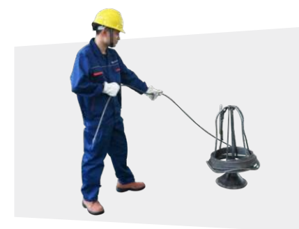
钢丝绳的正确解卷方式
