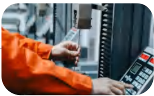
钢丝拉力试验
