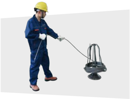
钢丝绳的正确解卷方式
