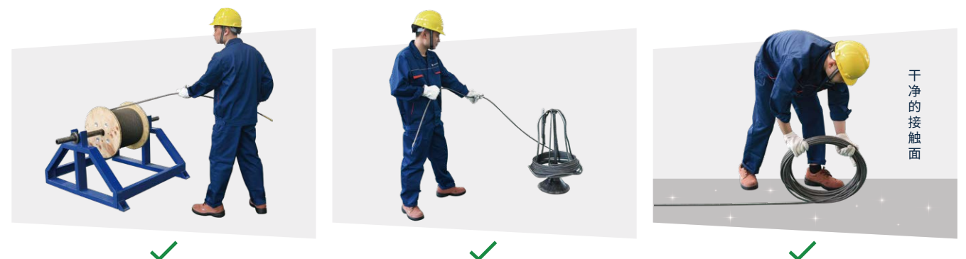
钢丝绳的正确解卷方式
