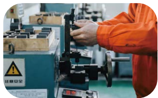
钢丝绳弯曲试验
