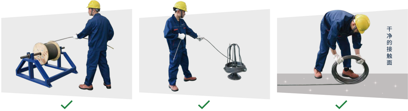
钢丝绳的正确解卷方式
